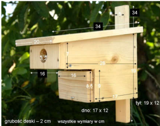
RYS. 4. WYMIARY BUDKI HORYZONTALNEJ.
